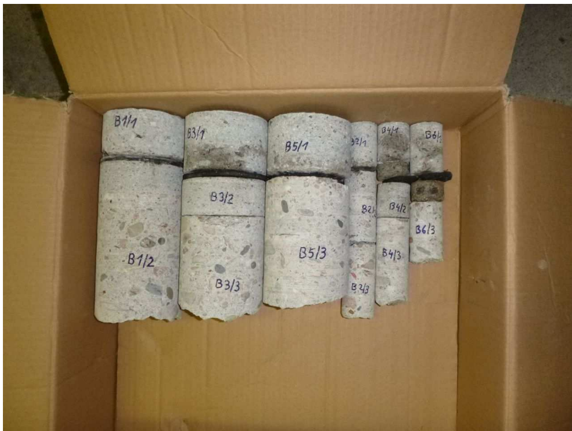
Celkový pohled na odebrané vývrt, patrná skladba konstrukcí ochozu (viz kap. 4)
